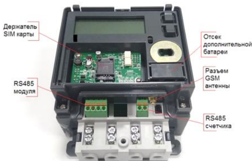
Рисунок 5.4 – Элементы подключения счетчика «Меркурий 204»
