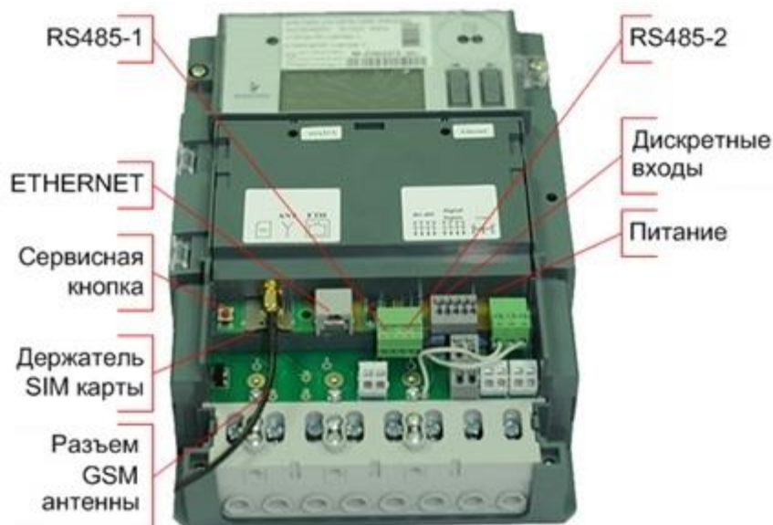
Рисунок 5.6 Элементы подключения модуля телемеханики
