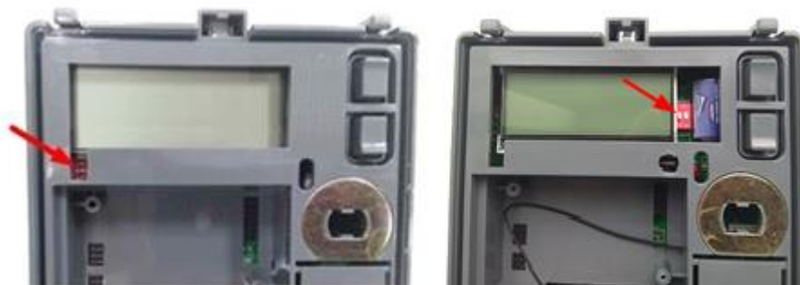
Рисунок 4.1 – Расположение переключателя блокировки управления нагрузкой счетчика «Меркурий 204»
