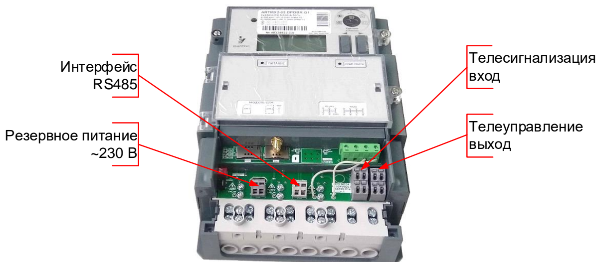
Рисунок 5.5 – Элементы подключения счетчика «Меркурий 234» с индексом «Х»
